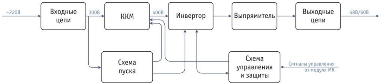
Рисунок 2 – Структурная схема модуля МП800
